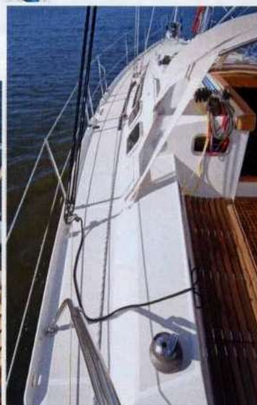
Sopra, il pozzo catena con il salpancora interno. Sotto, i passavanti sono di larghezza costante fino a estrema poppa.
