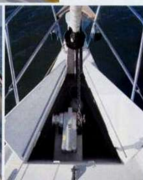
Sopra, il pozzo catena con il salpancora interno. Sotto, i passavanti sono di larghezza costante fino a estrema poppa.
