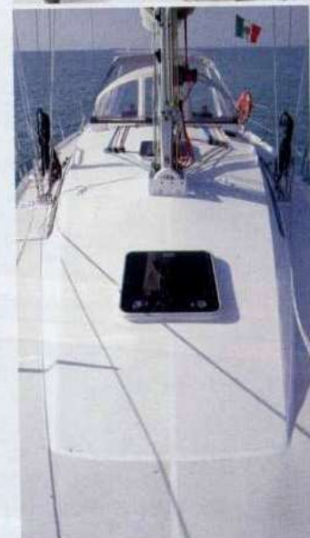
A sinistra, una visuale da prua del ponte. La tuga presenta due ampie zone prendisole proprio a lato dell'albero, che poggia in coperta. Di ottima tenuta l'antisdrucchio che riveste per intero le superfici orizzontali.
