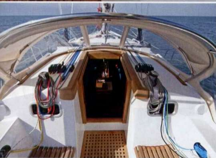
Sopra, la zona delle drizze e delle borose a circuito chiuso. Sotto a sinistra, la ruota di diametro ridotto; a destra, uno dei due gavoni gemelli.
